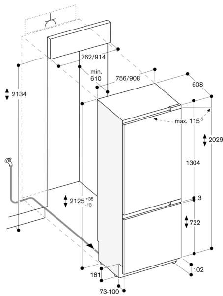
Le dimensioni massime del pannello porta sono progettate per una distanza di 3 mm.
