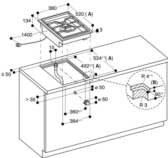
**A:** Per il montaggio della copertura dell'apparecchio considerare un'apertura più profonda (rispettare le precauzioni di montaggio separate)
