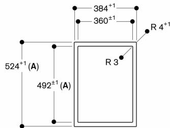
**A:** In caso di montaggio con coperchio apparecchio tenere presente il foro d'incasso più profondo (osservare le precauzioni di montaggio separate)
