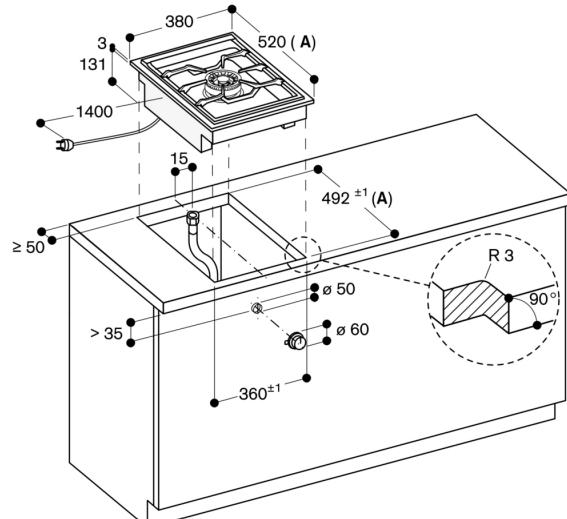
**A:** In caso di montaggio con coperchio apparecchio tenere presente il foro d'incasso più profondo (osservare le precauzioni di montaggio separate)
