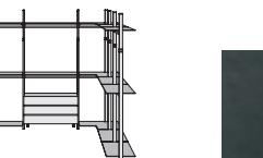
IL SISTEMA BREVETTATO EXTENDO È FORMATO DA DUE PROFILI IN ALLUMINIO ESTENSIBILI, ADATTABILI ALLE DIVERSE ALTEZZE DEGLI AMBIENTI. AGENDO SULLA LEVA A SCOMPARSA, I PROFILI SI BLOCCANO ALL'ALTEZZA DESIDERATA E SI COMPRIMONO TRA PAVIMENTO E SOFFITTO, SENZA L'UTILIZZO DI ALCUN UTENSILE O PRE-FISSAGGIO.
