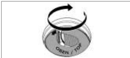
Fig. 7.9 Posizionare il filtro al carbone attivo nella posizione finale
