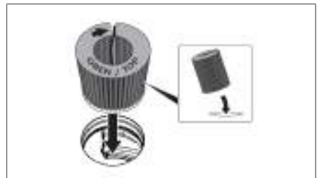
Fig. 7.8 Inserire il filtro al carbone attivo nell'apertura di aspirazione
