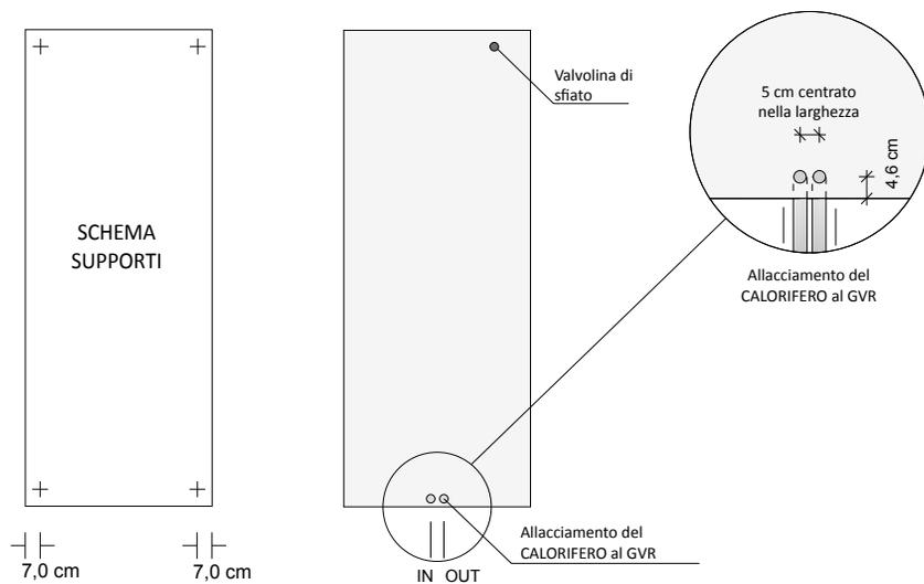
Il modello SQUARE è collegato all'impianto di riscaldamento mediante collegamento remoto GVR (Gruppo Valvole Remoto) fornito come accessorio.
