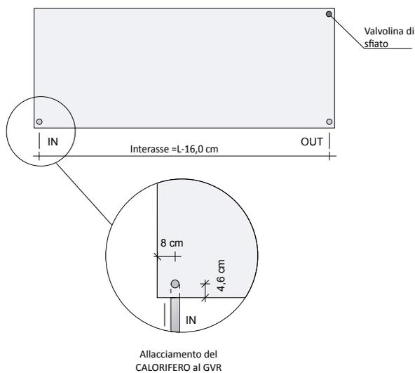
Il modello SQUARE è collegato all'impianto di riscaldamento mediante collegamento remoto GVR (Gruppo Valvole Remoto) fornito come accessorio.
